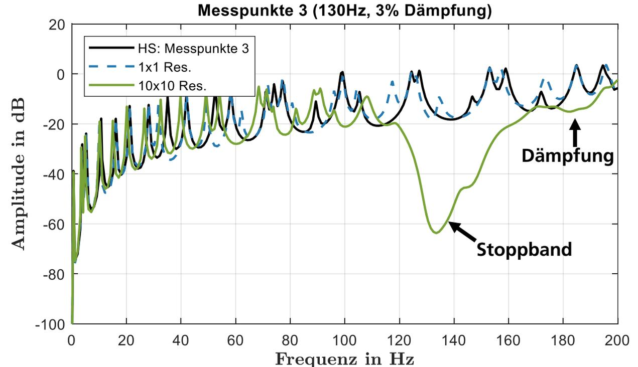
➔ Dämpfung in den Resonatoren wirken ab der Resonanzfrequenz
